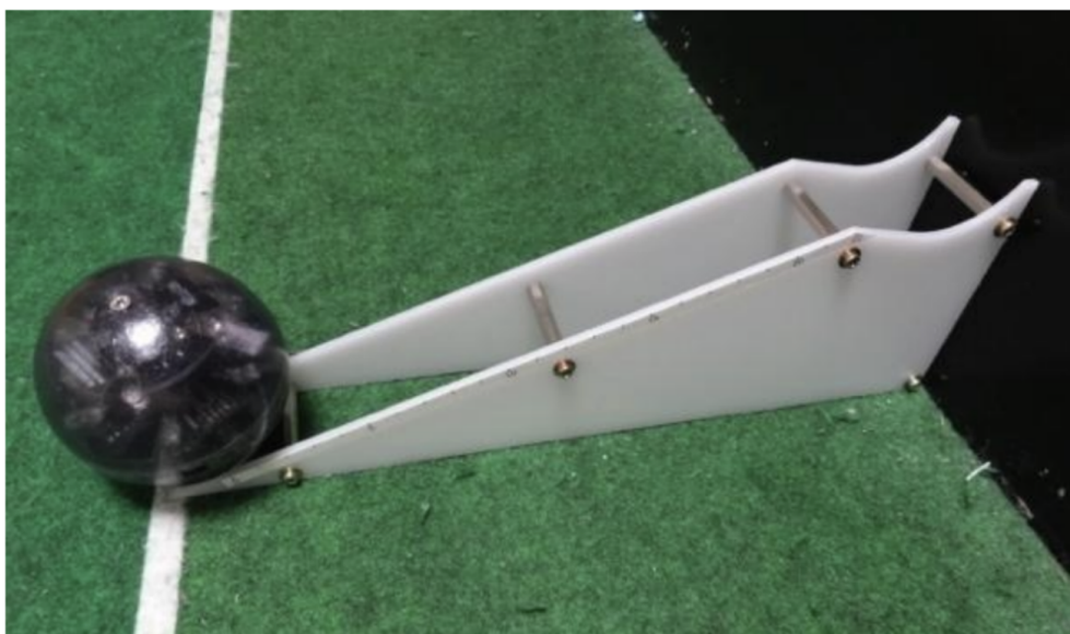
Рис 7. Устройство измерения силы удара робота
