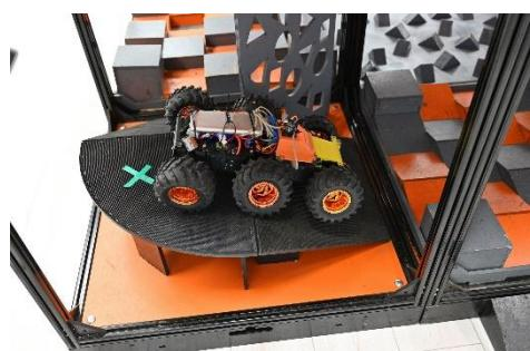
Куб, внутри которого расположено препятствие представляющая собой резкий подъем, поворот и спуск, высотой 200 мм. Препятствие покрыто резиной для лучшего сцепления робота с поверхностью.
