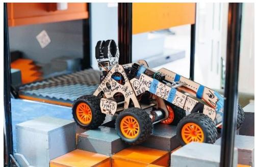
Ячейка заполнена 25-ю закрытыми прямоугольными коробами (рампами) разной высоты с перепадом высот в 50 мм.
