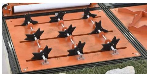
Плоское основание с параллельными прорезями. Внутри прорезей вращаются трёхлучевые звёзды, закрепленные на стержнях, расположенных **на верхней** стороне площадки. Звёзды выдаются над поверхностью максимум на 70 мм.
