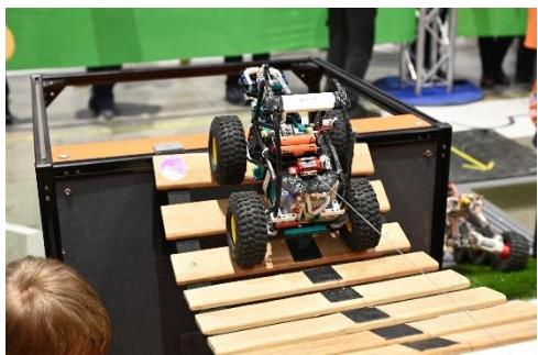
Подвесной мост собран из деревянных планок, закрепленных на стропах. Промежуток между планками составляет 15-20 мм. Длина моста варьируется, ширина 400 мм. На мосту нанесена линия контрастного цвета шириной 40 мм для автономного прохождения
