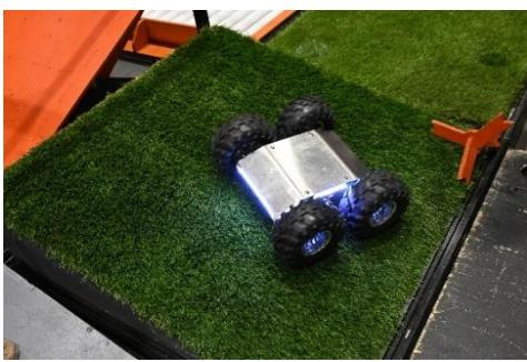
Плоская площадка, установленная под углом 15 градусов, на которой закреплена полоса искусственной травы. Высота ворса — 40 мм. Ширина искусственной травы может варьироваться.
