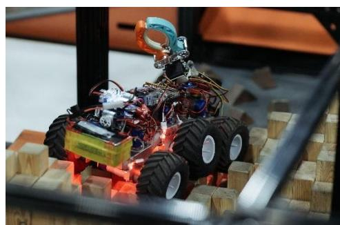
Конструкция из деревянных брусков 50x50мм разной длины, установленных вертикально, плотно друг к другу. Испытание размещается в одном стандартном кубе высотой 800 мм.
