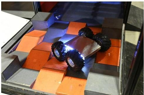
Ячейка заполнена 25-ю закрытыми коробами (рампами). Верхняя грань каждого короба имеет наклон в 15°. Рампы составлены таким образом, что их верхние поверхности образуют по высоте волнообразную структуру.
