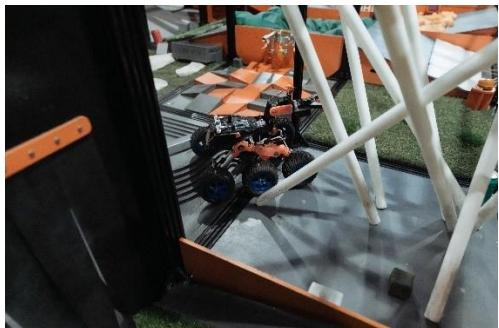
Куб, верхняя грань которого представляет собой площадку с закрепленными на ней разнонаправленными полипропиленовыми трубами. Трубы опираются на нижнюю грань куба.
