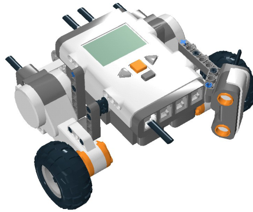
Рис. 11. Увеличенное за счет корпуса робота расстояние до стены способствует расширению области обзора
