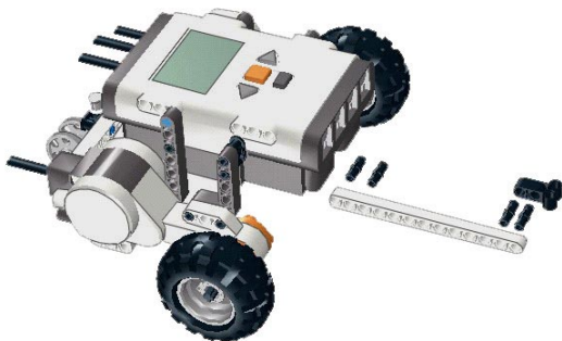
Рис. 5. Датчик расстояния слегка выносится вперед
