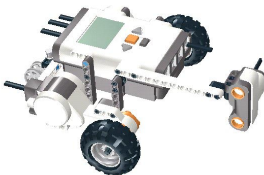
Рис. 7. Оптимальный вариант – вертикальное расположение датчика
