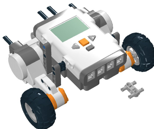
Рис. 9. Крепление для датчика размещается на левой стороне
