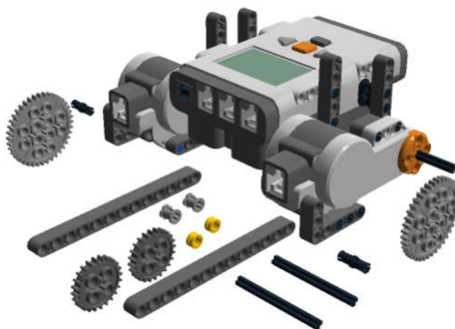
Рис. 8.59. NXT устанавливается на два модуля ниже, чем обычно.
