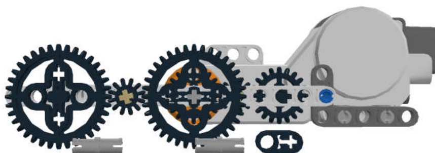
Рис. 3.56. Черная двухмодульная балка заменит недостающую шестерню.
