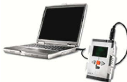
Рис. 5.2. Соединение NXT с компьютером через USB.
