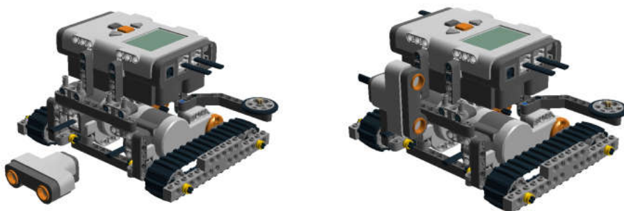
Рис. 8.122. Установка первого датчика расстояния сзади, направление вправо.
