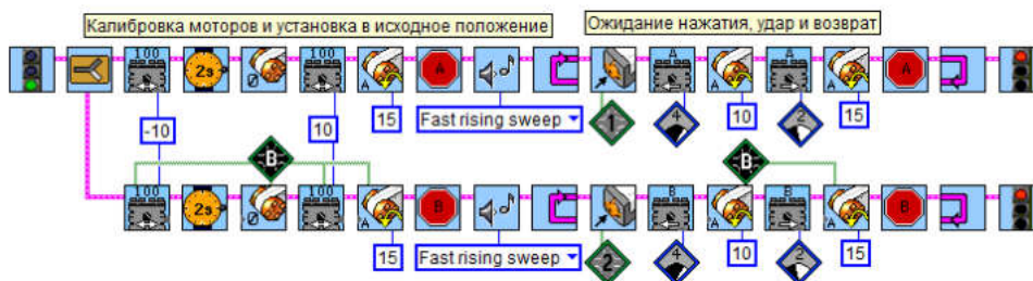
Рис. 8.102. Алгоритм управления палочками с помощью двух датчиков.
