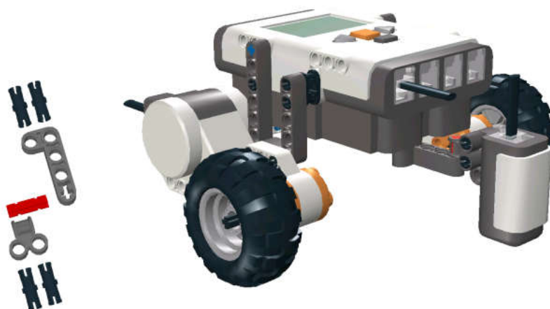
Рис. 8.13. Трехколесная тележка с креплением датчика освещенности.
