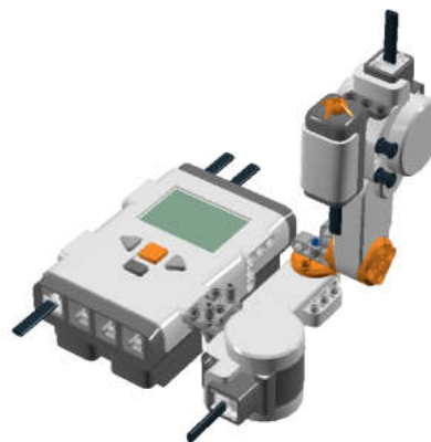
Рис. 8.143. Датчик касания на джойстике.
