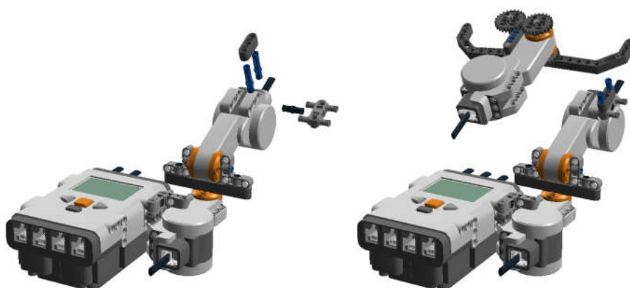
Рис. 8.156. Установка мотора с захватом на оранжевый диск второго мотора.
