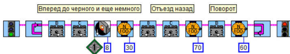
Рис. 8.17. Алгоритм «Танец в круге» с выталкиванием кеглей.
