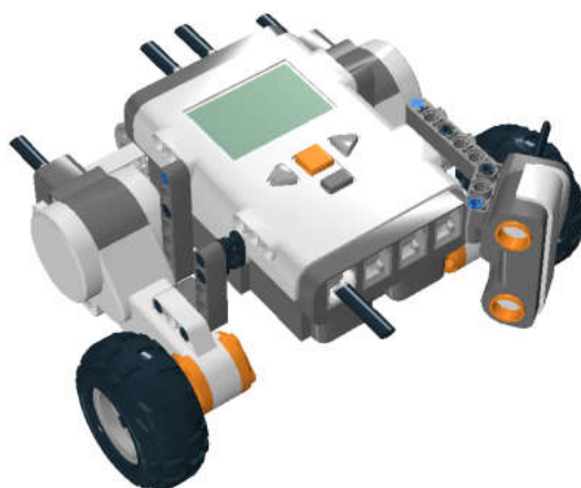
Рис. 8.91. Увеличенное за счет корпуса робота расстояние до стены способствует расширению области обзора.
