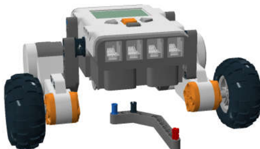
Рис. 8.33. Крепление датчика освещенности к трехколесной тележке.
