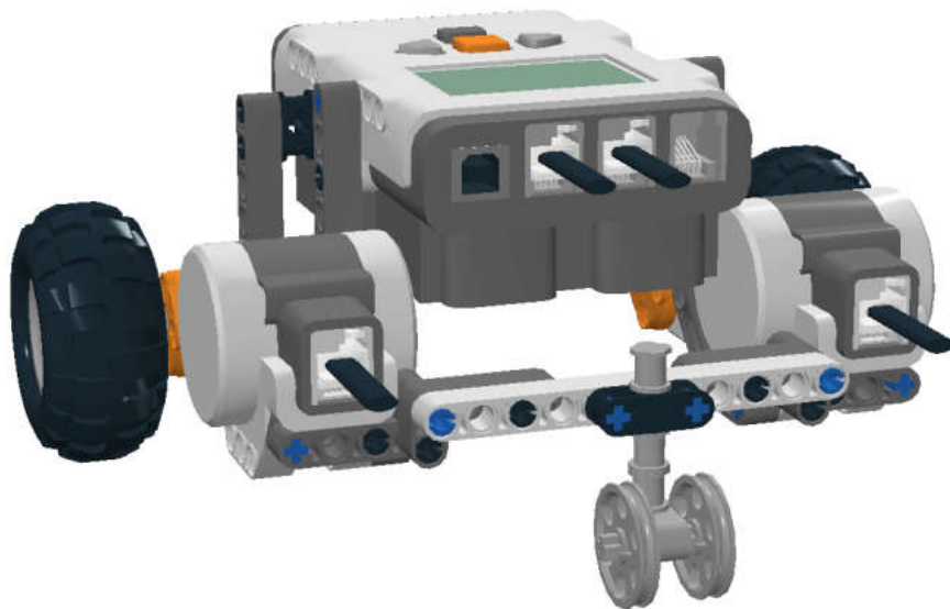
Рис. 3.85. Корпус такой тележки расположен горизонтально и колесико вращается вокруг вертикальной оси свободно.
