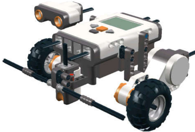
Рис. 8.23. Ультразвуковой датчик для поиска кеглей и модифицированный бампер.
