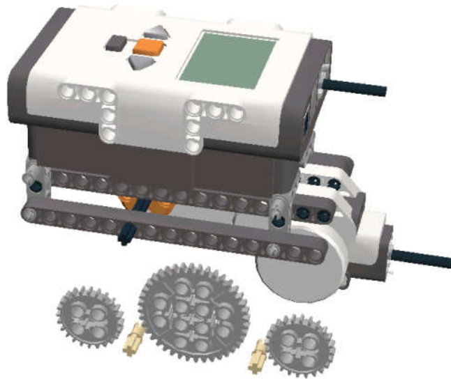
Рис. 3.40. На ведущие оси насаживаются 24-зубые шестерни.
