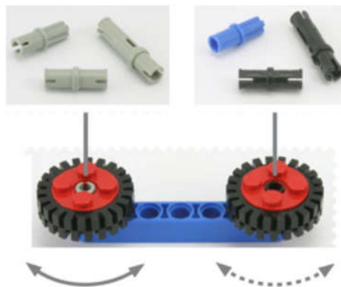
Рис. 2.4. Серые штифты и бежевые штифты-полуоси предназначены для вращения, а черные и синие – для фиксации [3].
