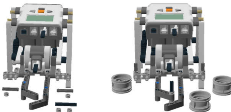
Рис. 3.67. Три вертикальных оси для установки колесных дисков.
