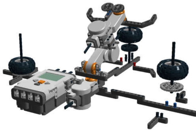
Рис. 8.158. Установка стержней для стаканчиков в трех позициях.
