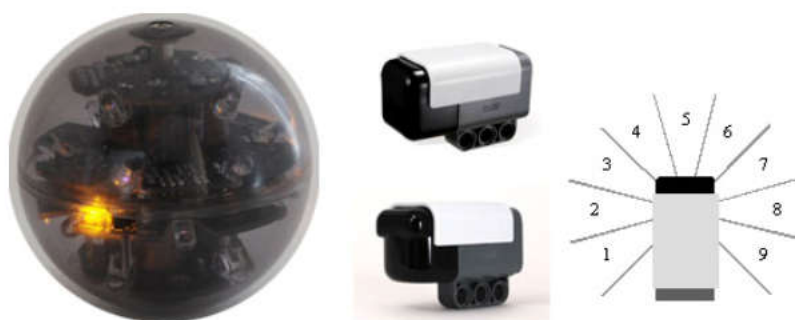
Рис. 7.16. Инфракрасный мяч (слева), компас (в центре сверху), инфракрасный поисковик (в центре снизу) и его секторы обзора (справа).
