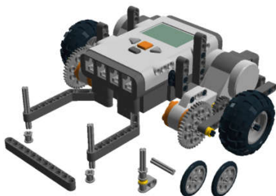
Рис. 8.64. Для установки датчиков использованы 5-модульные оси, чтобы приподнять их над поверхностью.
