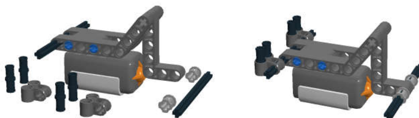
Рис. 8.87. Нажатие осуществляется «пяточкой» изогнутой балки 3 × 5.
