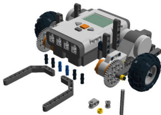
Рис. 8.63. Подвижное колесо спереди будет совмещено с креплением датчиков.
