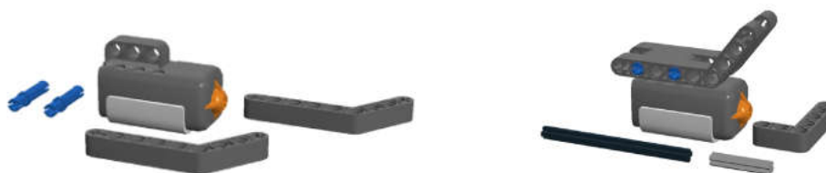
Рис. 8.86. Эффективная конструкция для датчика касания.
