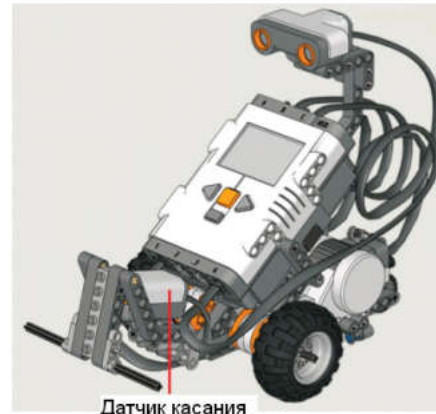
Рис. 8.84. Бампер с датчиком касания для маленького исследователя.
