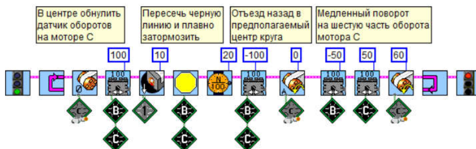
Рис. 8.22. Алгоритм «Танец в круге» с датчиками оборотов.
