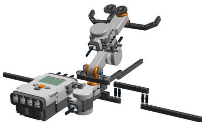
Рис. 8.157. Установка опор для манипулятора.
