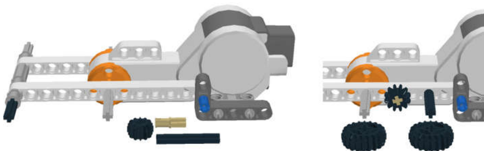
Рис. 3.53. Шестерня 12-зубая ставится на бежевый штифт с поворотом на ползубца.
