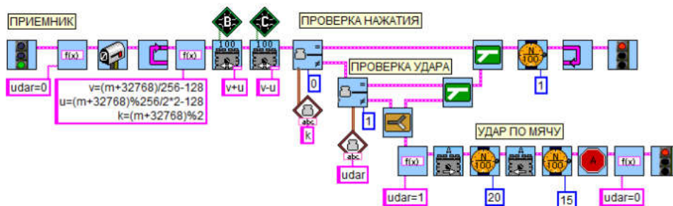
Рис. 8.146. Удар по мячу роботом с третьим мотором.
