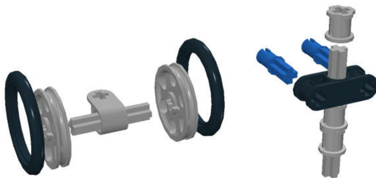
Рис. 3.80. Сборка заднего подвижного колеса. Обе оси должны вращаться свободно.
