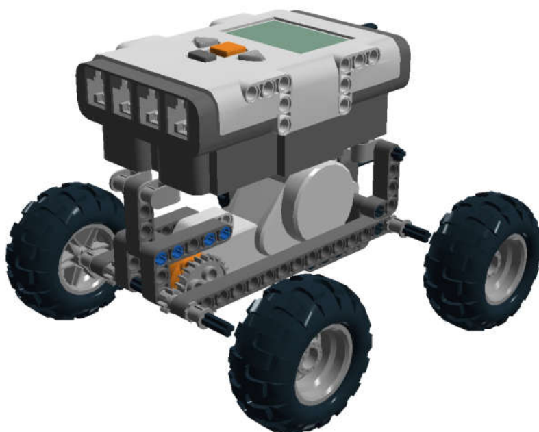
Рис. 3.26. Повышающая передача 1 : 3 для скоростной тележки.
