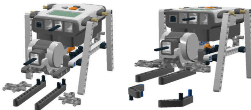
Рис. 3.66. Балки 11-модульные на черных штифтах крепятся под двигателем.
