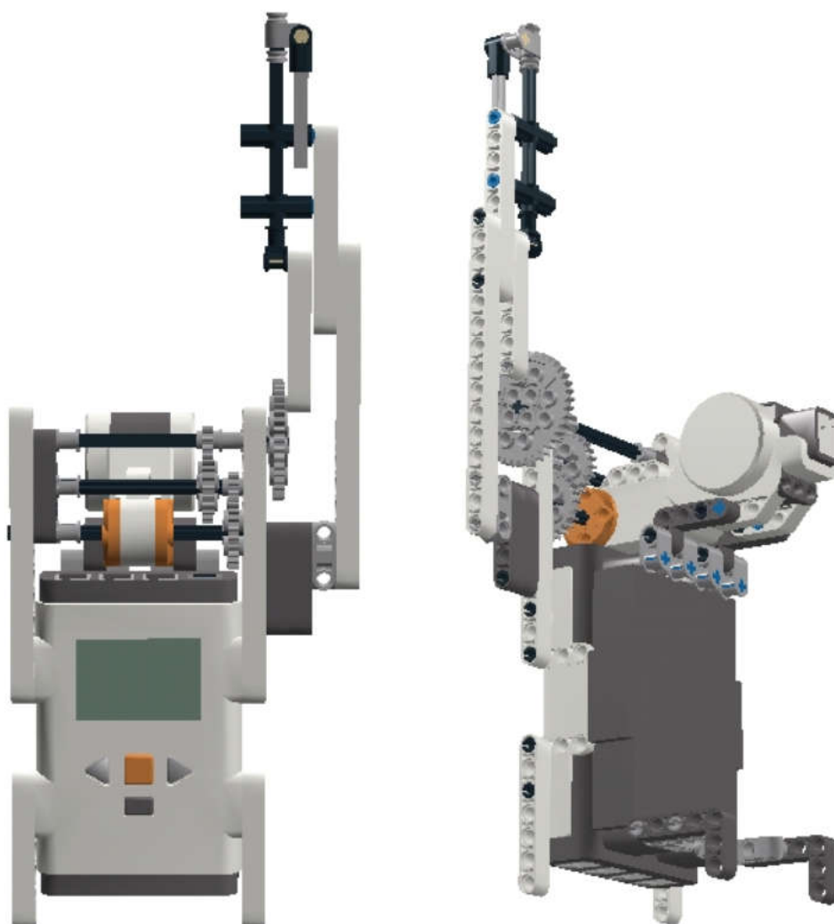
Рис. 3.70. Модель маятника Капицы, выполненная из деталей Mindstorms. Передача 1 : 9.
