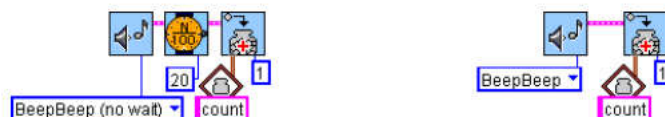
Рис. 8.53. Задержка при увеличении счетчика: слева — с помощью блока времени, справа — с помощью звукового сигнала.
