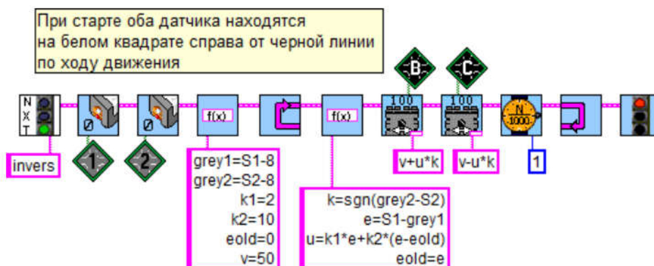
Рис. 8.76. Алгоритм следования по инверсной линии с двумя датчиками освещенности.
