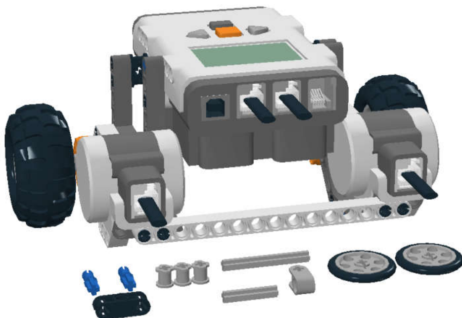
Рис. 3.79. Элементы подвижного колеса. Длины осей — 3 и 5 модулей.
