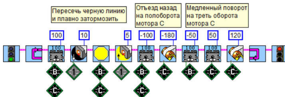
Рис. 8.20. Алгоритм «Танец в круге» с движением по датчикам оборотов.
