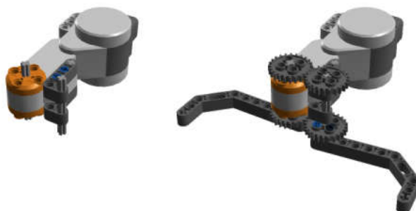
Рис. 8.151. Установка захвата на второй мотор.
