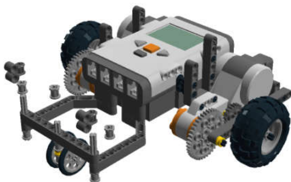
Рис. 8.65. Поперечная балка будет основой для подвижного колеса.
