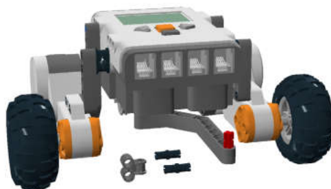
Рис. 8.34. Ось для регулировки высоты датчика может быть любой длины.
