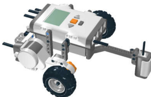
Рис. 8.35. Высота датчика над поверхностью поля — от 5 до 10 мм.
