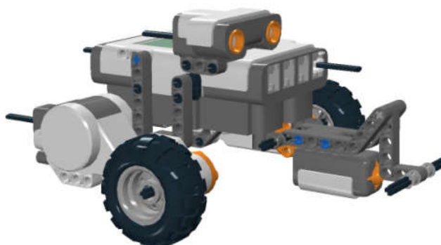
Рис. 8.88. Конструкция с датчиком крепится непосредственно к NXT.
