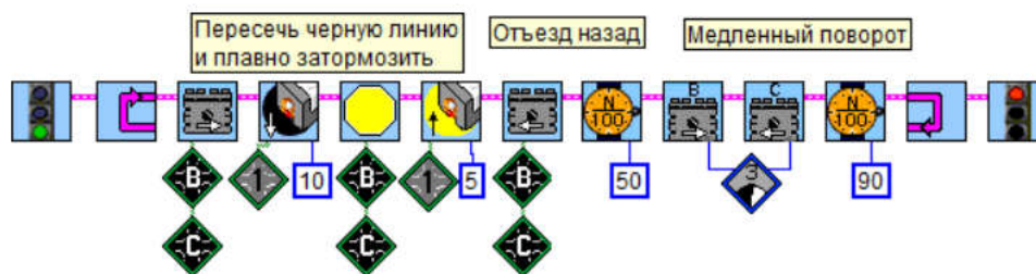
Рис. 8.19. Алгоритм «Танец в круге» с плавным торможением.
