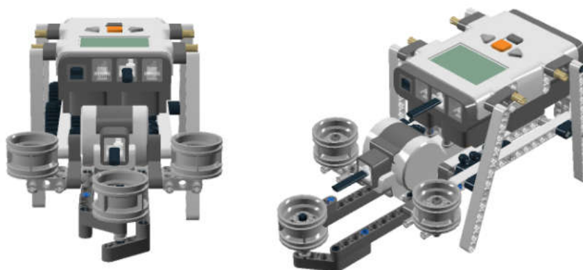
Рис. 3.68. Такой робот интересен тем, что может путешествовать, самостоятельно обходя стены.
