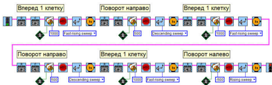
Рис. 8.119. Пример программы прохождения трех ячеек лабиринта.
