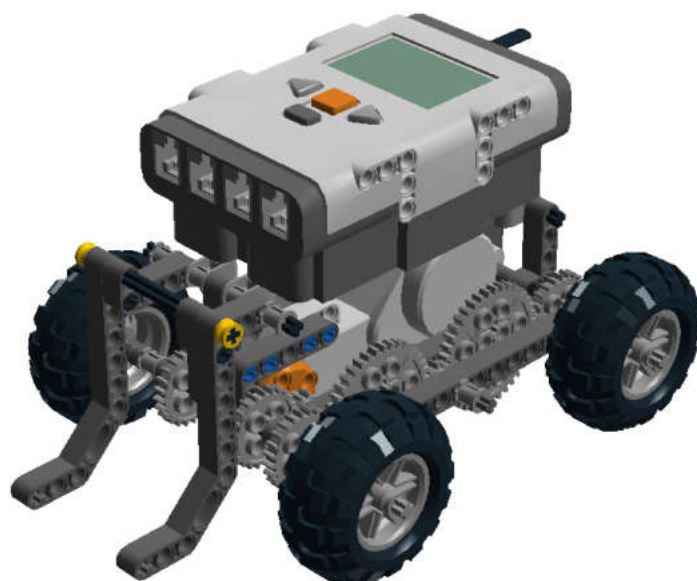
Рис. 3.35. Бампер не касается поверхности.
