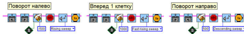
Рис. 8.118. Реализация трех базовых команд для лабиринта на языке RoboLab.
