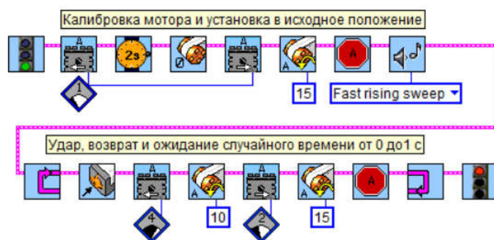
Рис. 8.100. Управление палочкой с помощью датчика касания.
