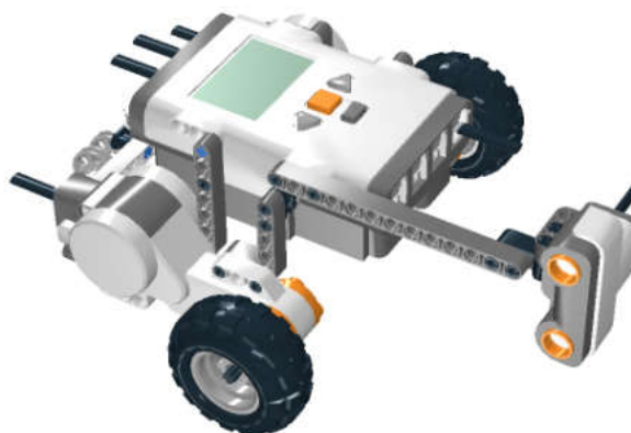
Рис. 7.29. Оптимальный вариант — вертикальное расположение датчика.
