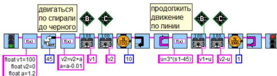
Рис. 8.31. Движение по спирали с последующим движением по линии с помощью датчика освещенности.
