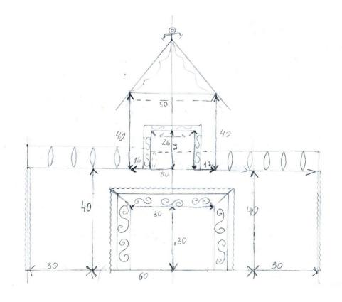
Материал для изготовления теремка должен быть экологически безопасным для животных, поэтому было принято решение использовать обессмоленную березовую фанеру. Для более точной резки фанеры решено было воспользоваться лазерным станком.
