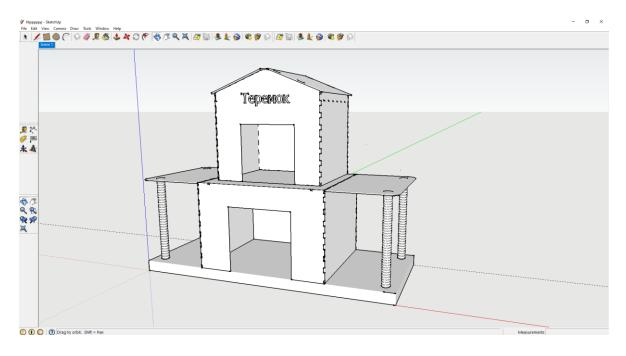
3D-модель создается подетально, элементы соединяются друг с другом соединением шип-паз. После чего детали раскладываются на плоскость и экспортируются из 3D в 2D.
