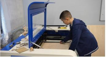
Лазер с высокой точностью вырезает модель по параметрам.
