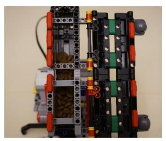
Для вращения ленты, по которой идёт подача корма, используется блок EV3, большой мотор и детали конструктора.
