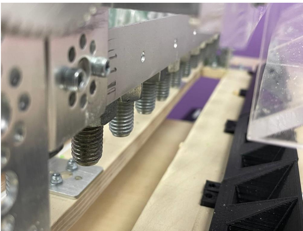
Рисунок 10. Вид на этап подготовки углублений для семян и приспособления для центровки семян.
