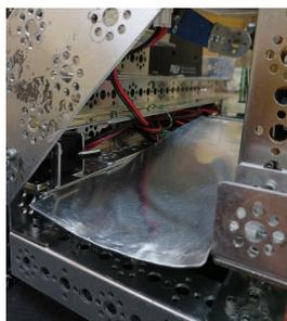
Также во время тестов мы обнаружили, что не можем доставлять грузы на перевешенный общий хаб, поэтому мы погнули крайнюю часть пандуса. Таким образом, когда груз толкается, он поднимается на нужную для сброса на общий хаб высоту.
