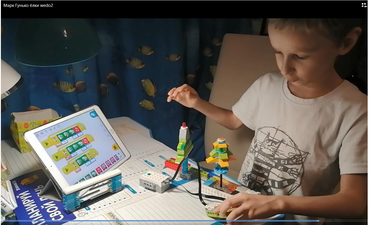
Рис. 3. Вращение ёлочек с помощью мотора под управлением датчика наклона
