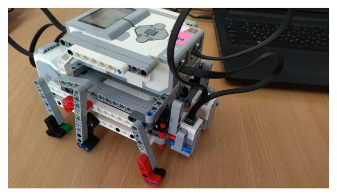
Робот «Deeppi» для программы Марафон шагающих роботов выполнен из Лего EB3. Оснащен двумя датчика цвета, 2 большими моторами, имеет 6 конечностей.
