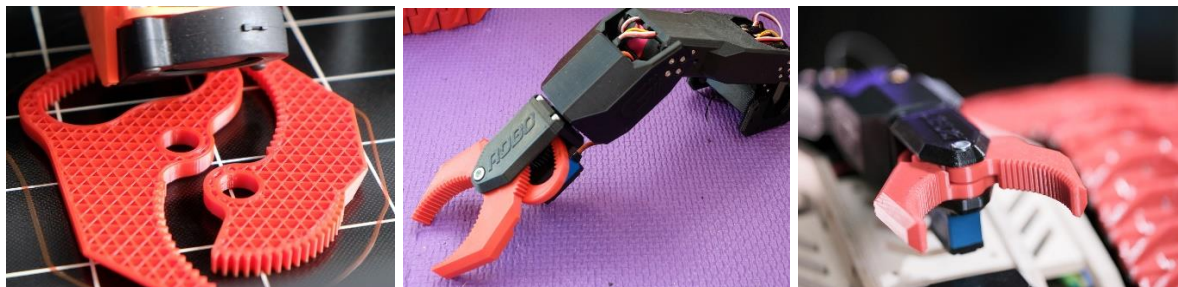
Рис.5. Роборука и поворотный захват
