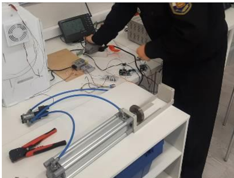
Рис. 8 Стенд для проверки работы системы управления
