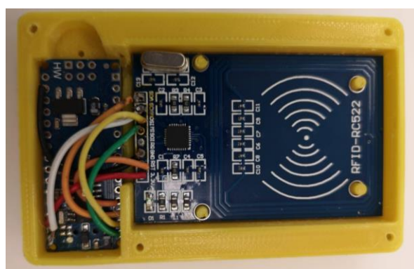
Рис. 13. Реальная модель считывателя RFID и Arduino Nano в корпусе, напечатанном на 3d принтере
