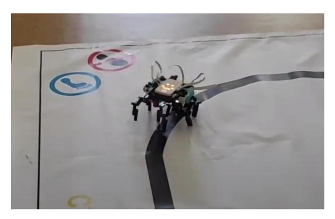
Шагающий робот, сконструированный с использованием набора LEGO® Education SPIKE<sup>TM</sup> Prime. Робот оснащён двумя крупными моторами, предназначенными для приведения в движение шагающих механизмов, вероятно, каждый мотор приводит в движение одну сторону робота, обеспечивая его движение путём чередования шагов.
