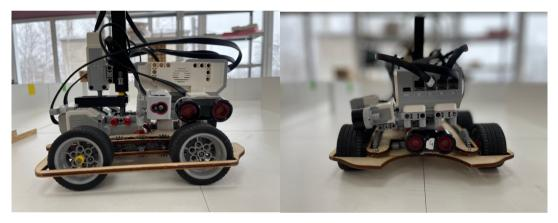
У робота установлены 4 колеса, с помощью шестеренок, движение передаётся на передние и задние колеса. Передаточное отношение 5:3 Так же на лазерном станке сделано основание из фанеры для усиления конструкции робота и помогает держать нужное расстояние датчика света от стены, для лучшей идентификации жертв.
