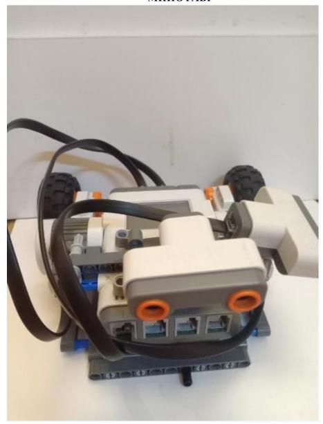
Робот представляет собой двухмоторную тележку, оснащенную двумя ультразвуковыми датчиками. Датчики позволяют определять наличие стены справа и стены спереди. При отсутствии стены справа робот делает правый поворот. При наличии стен спереди и справа робот делает левый поворот. При отсутствии стены спереди и наличии стены справа робот едет вперед.
