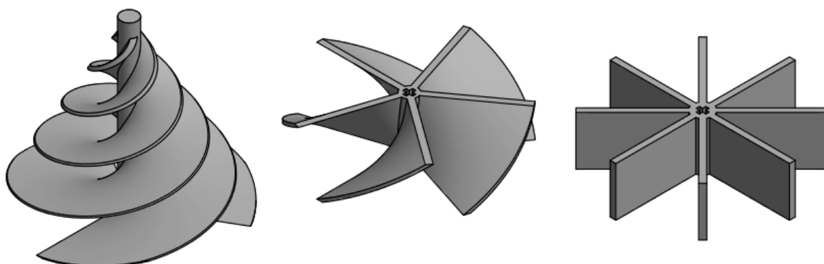
Рис. 2.10 Типы исследованных роторов: ротор Онипко, ротор с винтообразными лопастями, ротор с прямыми лопастями.
