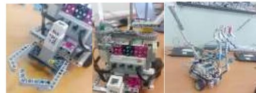
Лебедь два больших мотора для передвижения, два датчика цвета для движения по линии, средний мотор и зубчатая передача для движений крыльев, захват пальцевый на зубчатой передаче на среднем моторе
