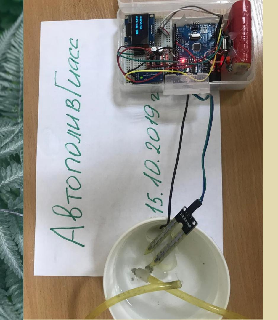
При падении влажности почвы блок управления включает насос и начинает орошать растение. Для удобства использования уровень влажности и отклонение от нормы выводится на дисплей. Устройство работает автономно
