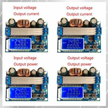
помощью кнопок микросхеме на можно чтобы переключать режимы, визуально контролировать напряжение какое подается источников и какое получается на выходе после преобразования.
